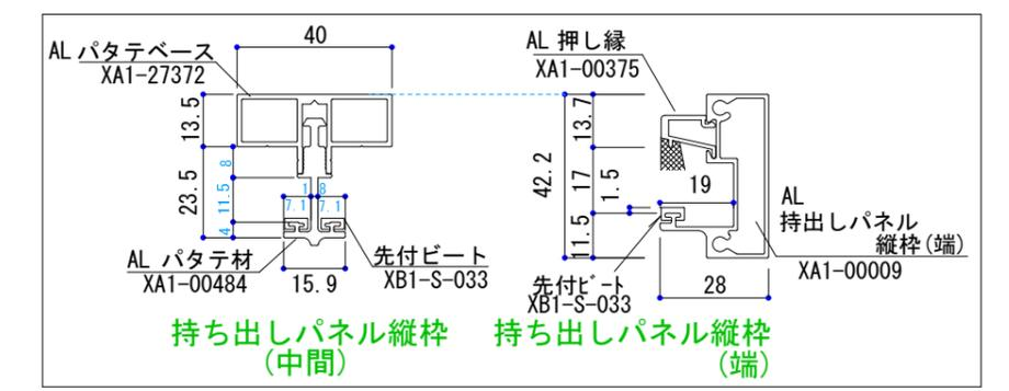
持ち出しパネル縦枠 (中間) 持ち出しパネル縦枠 (端)
